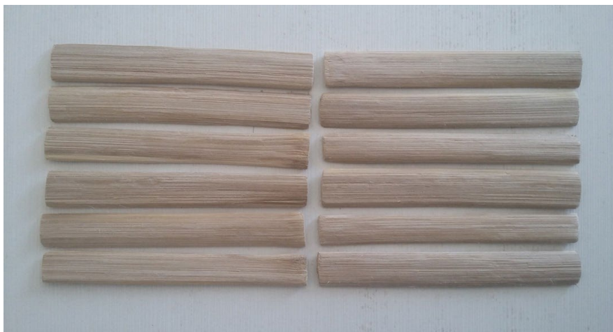
Figura 1. Ripas de Bambusa vulgaris antes do processo de tingimento. Fonte: os autores.
