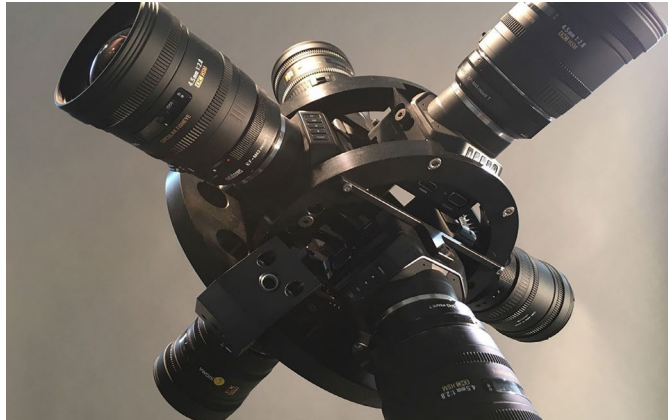
Figura 24. Rig de 6 cámaras Blackmagic Studio 4k con lentes Sigma 4,5 mm. Fuente: http://www.helhed.de/en/rental-en/ .
