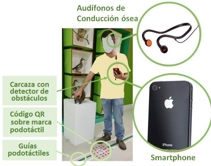
Figura 4. Prototipo desarrollado a partir del sistema diseñado y constituido por señales podotáctiles, códigos QR, Smartphone (software para iOS), audífonos de conducción ósea y sensor de presencia. Fuente: elaboración propia por parte de los autores.
